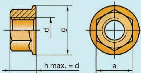
EXEMPLE DE DÉSIGNATION d'un écrou hexagonal de cote  $d = M10$  et de classe de qualité 08 (ou la matière)\* :
